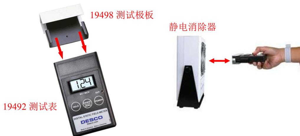
如果静电消除器的正负离子是交替输出的情况，屏幕读数会连续变化，当正负离子的交替输出频率快于测试仪显示速度时，测试仪显示的是平均值。采用信号输出到记录仪可以更精确的测量实际值。
